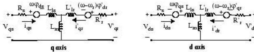
$$V_{qs} = R_s i_{qs} + \frac{d}{dt} \phi_{qs} + \omega \phi_{ds}$$
